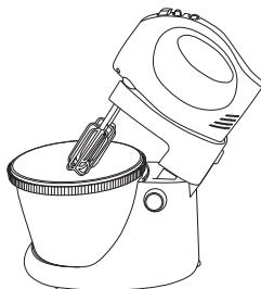
Нажмите на кнопку 8 чтобы снять блокировку моторного блока ⑦ и другой рукой снимите моторный блок ⑦. Для высвобождения насадок нажмите кнопку ③ и выньте насадки.
